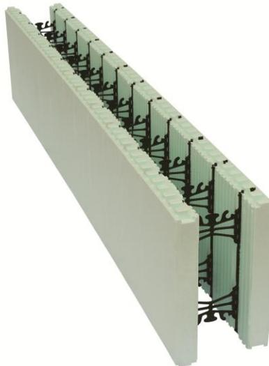
Les panneaux PSE et les bandes de fixation sont moulés avec un mécanisme préformé d'emboîtement réversible et de verrouillage vertical par clips sur leurs bords supérieur et inférieur pour faciliter l'empilage et l'emboîtement vertical des unités de coffrage.
